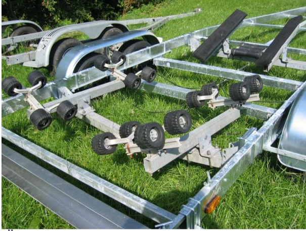
Übernahme vorhandener Auflagen auf Pfaff Trailer Umbau Amerikanischer Bootsanhänger auf Trailer nach Bestimmungen der StVZO
