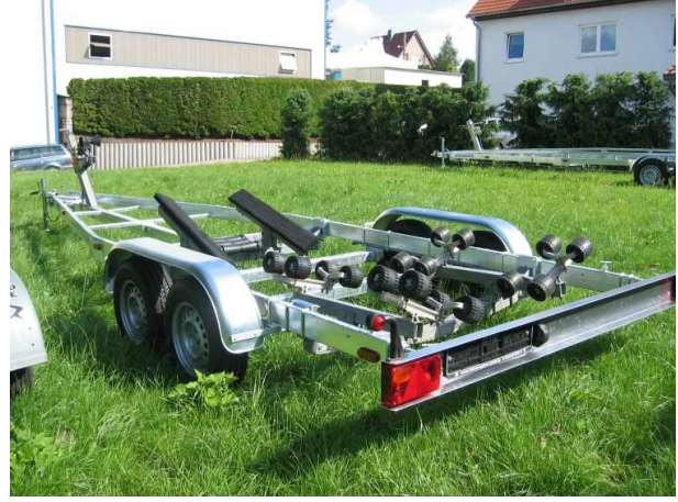
Übernahme vorhandener Auflagen auf Pfaff Trailer Umbau Amerikanischer Bootsanhänger auf Trailer nach Bestimmungen der StVZO
